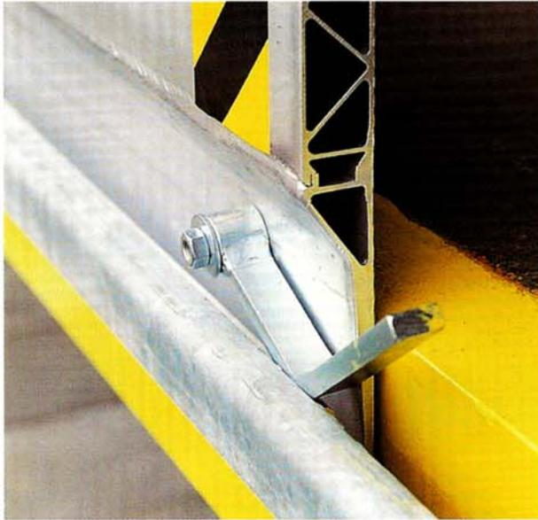
Eine Fallsicherung rastet beim Hochklappen der Brücke automatisch ein. Das Lösen der Sicherung erfolgt mit dem Fuß und des seitlich angebrachten Rückzughebels.
