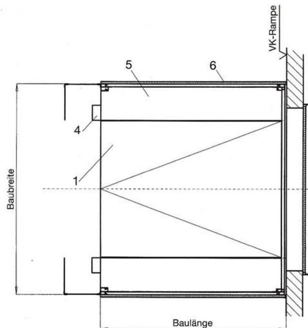
1. Hydraulische Überladebrücke MTV/MTK
